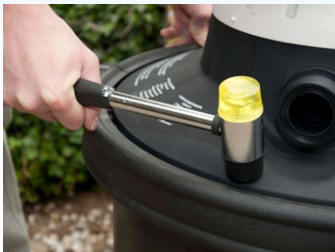
Gebruik de hamer om het deksel op zijn plaats te krijgen
