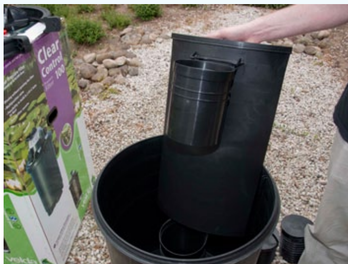
Haal de tussenwand uit het filter
